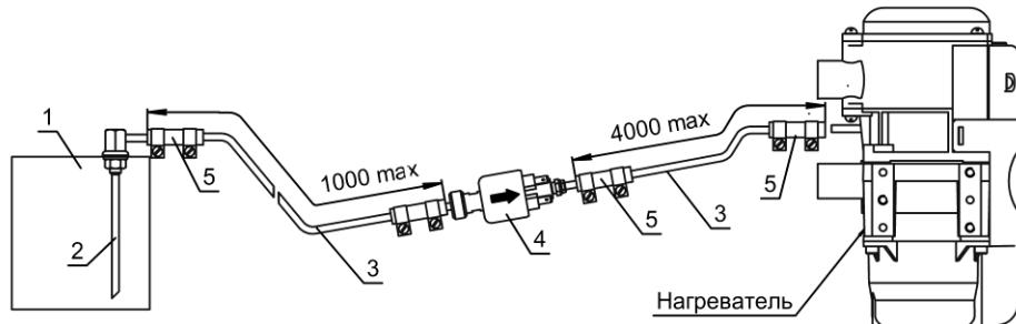
1 Топливный бак      4 Топливный насос
