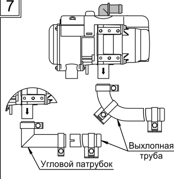
Выхлопную трубу нужно прокладывать с уклоном вниз от подогревателя. Если это невозможно, то нужно в самой нижней точке сделать отверстие Ø3 мм для слива конденсата.
